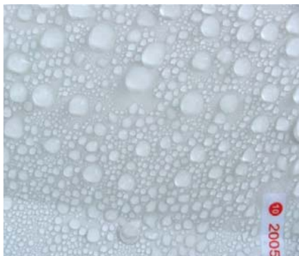
Rys. 1. Zjawisko kondensacji w obudowie: na powierzchni obudowy (z lewej) oraz na powierzchni aparatów
